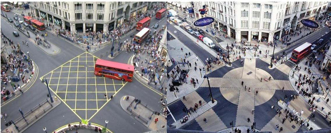
Abbildung 9: Vereinfachung der Wegführung für Fußgänger durch Einführung einer diagonalen Querungsmöglichkeit
